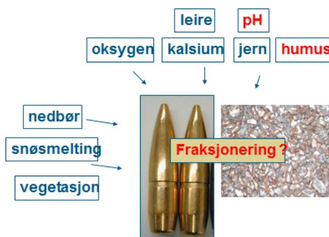
Figur 10. Faktorar som påverkar korrosjon av prosjektil.
