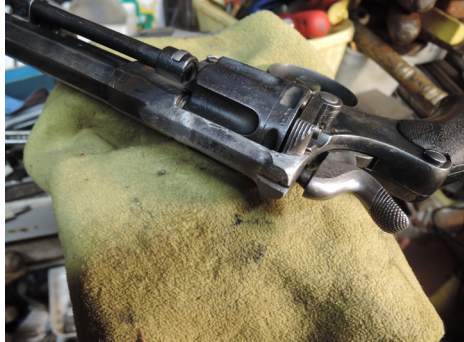
Tønne reparert og baksikte filt opp.
