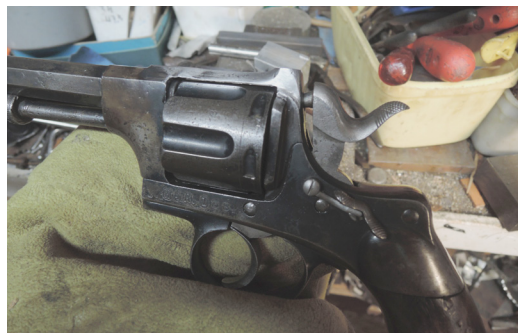
Baksikte filt til og klart for filing av V fuge.
