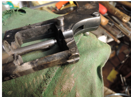
Baksikte filt til og klart for filing av V fuge.
