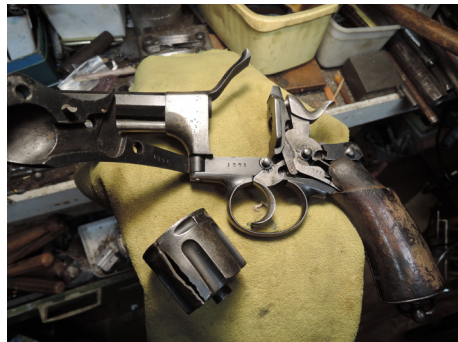
Tønne sprengt, toppstrap bøyd.
