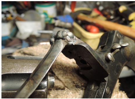
Toppstrap bøyd på plass og TIG sveiset.
